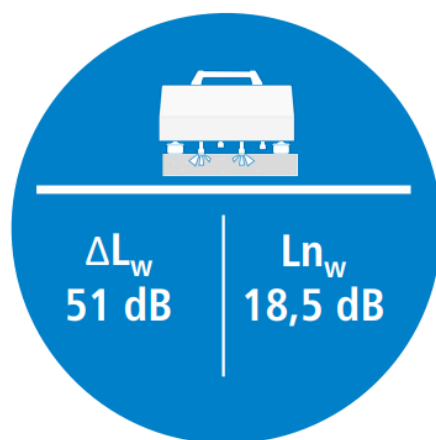
Efikasnost izolacije poda Gym Floor Base
